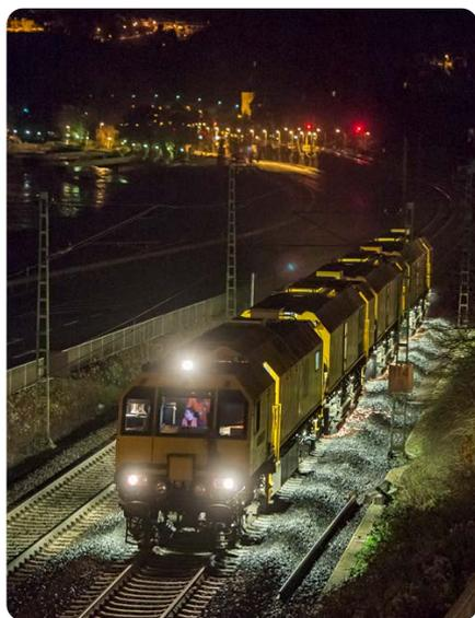
Spezialzug im Einsatz: Beim BüG werden Unebenheiten auf der Schiene abgeschliffen.
