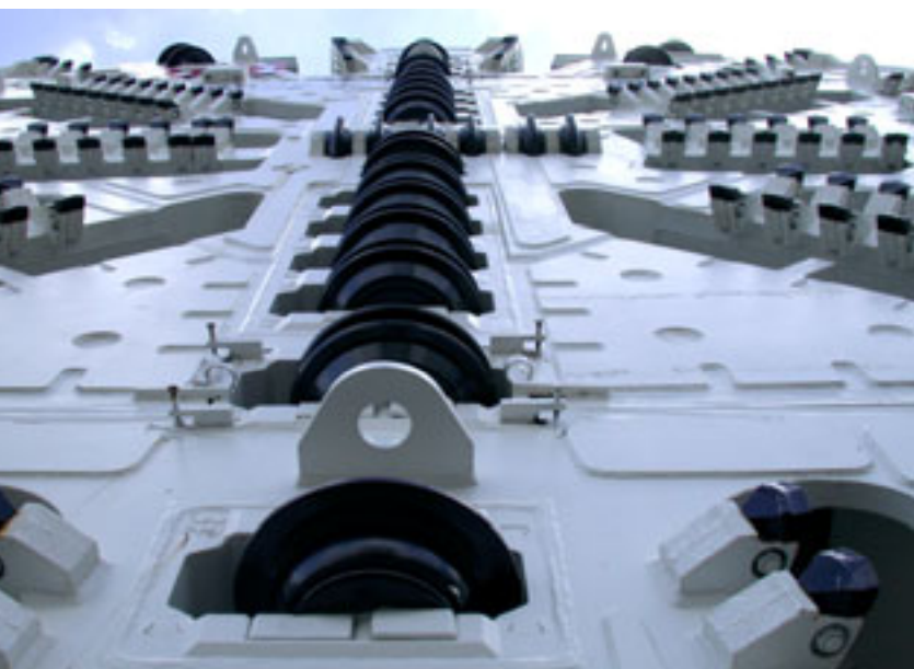
Das Schneidrad der Tunnelvortriebsmaschine hat einen Durchmesser von 11,16 Metern.
