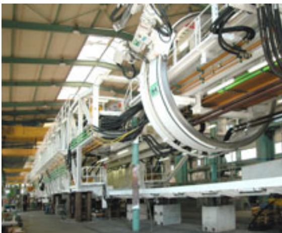
Tunnelvortriebsmaschine bei der Endmontage
