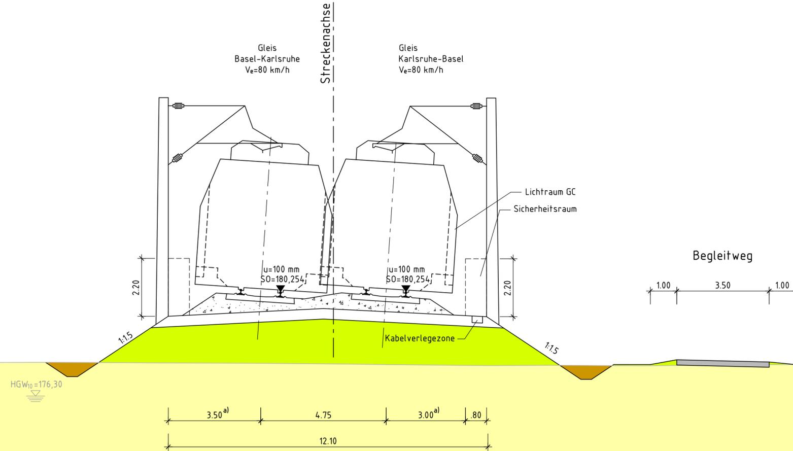
a) = Regelmaße bei Gleisüberhöhung u=55 bis 100 mm
