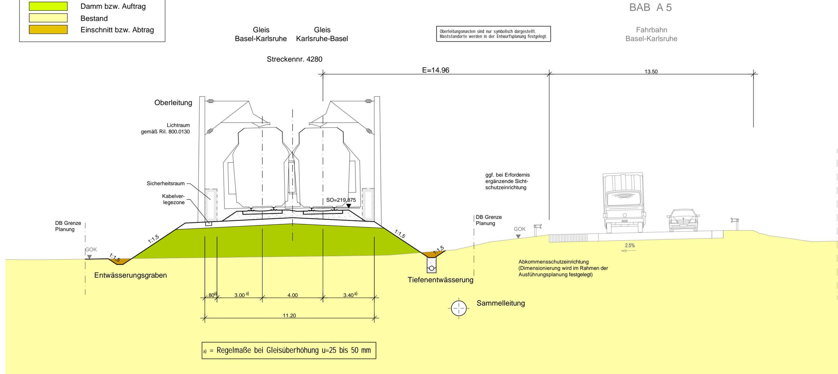
a) = Regelmaße bei Gleisüberhöhung u=25 bis 50 mm
