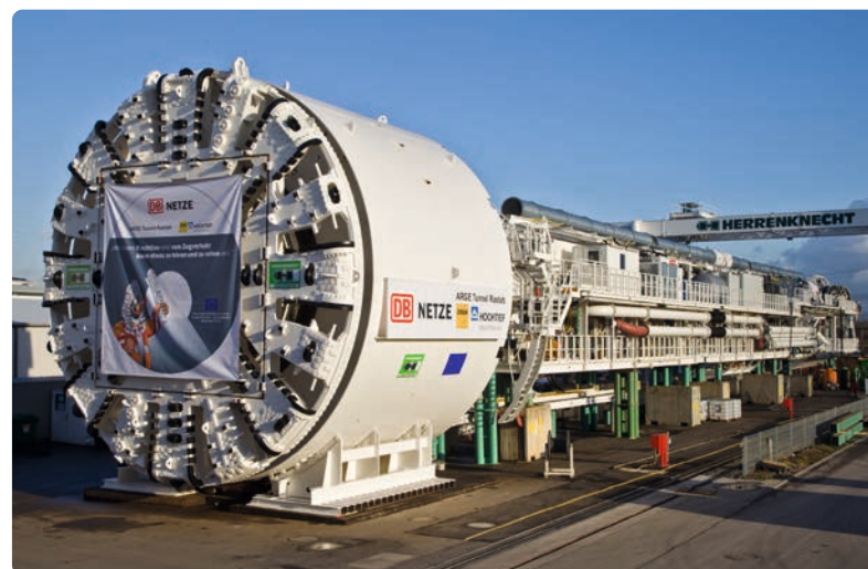
Eine der beiden TVM vor dem Einsatz im Rastatter Tunnel
