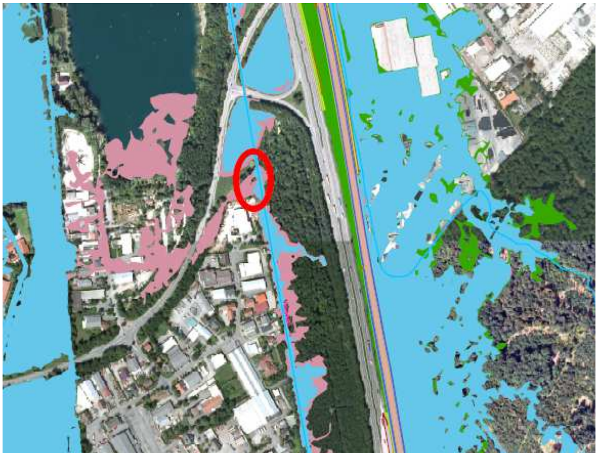
Abb. 4-3: Ausuferungen linksseitig des Feuerbachs im RZ, roter Kreis markiert hydraulische Schwachstellen
