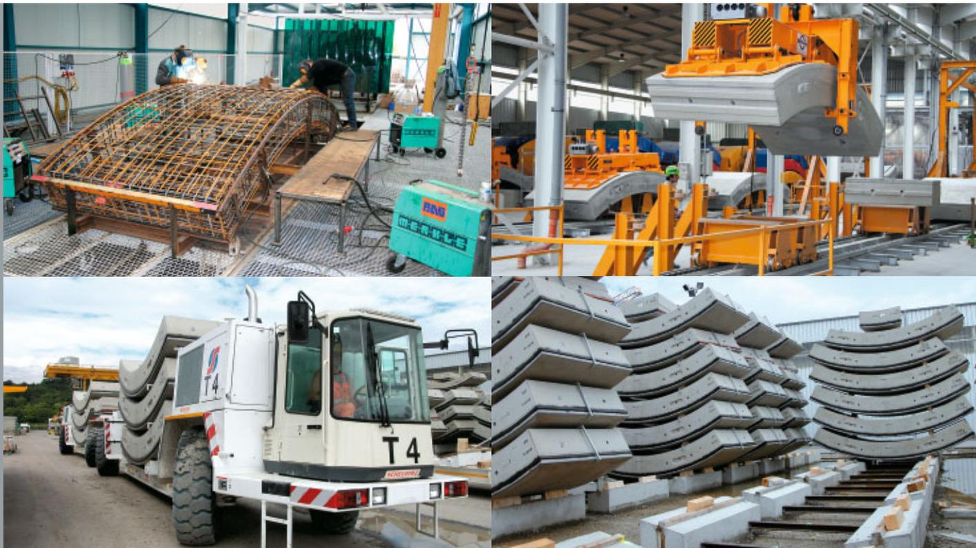
Produktion und Lagerung der Tübbinge (Stahlbetonfertigteile) direkt vor Ort
