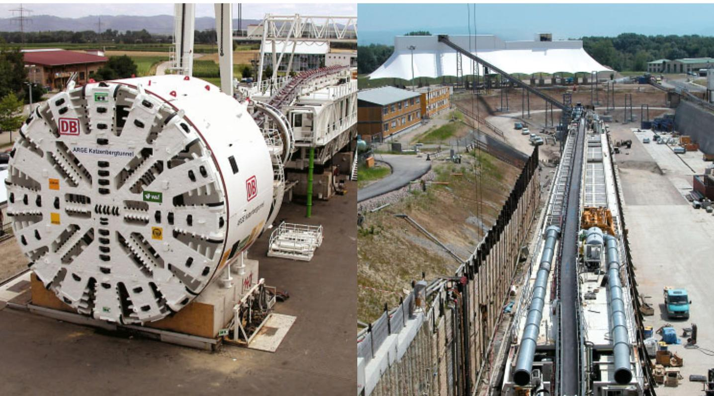
Tunnelvortriebsmaschine (links) und Förderband im Nachläufer der Maschine (rechts)
