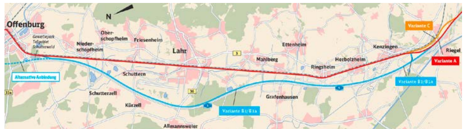
Die blau eingefärbte Variante B zeigt die autobahnparallele Lage der Gleise.
