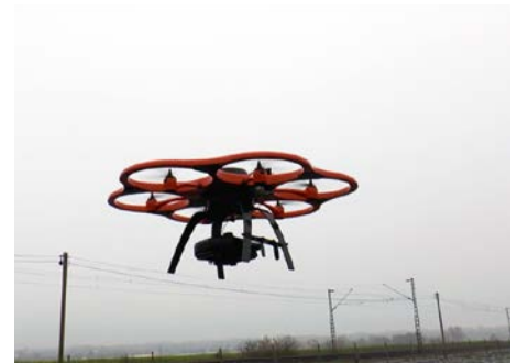
Drohne im Einsatz: Mit fliegenden Kameras wird der Streckenabschnitt 7 vermessen.
