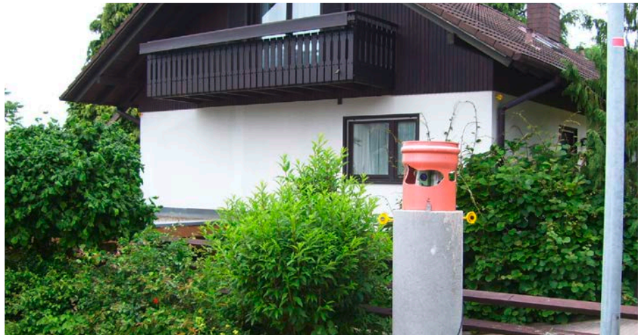
Bei der Beweissicherung wird mithilfe eines Tachymeters die genaue Lage eines Gebäudes bestimmt. So wird erkannt, ob sich das Haus durch die Bauarbeiten „bewegt“.
