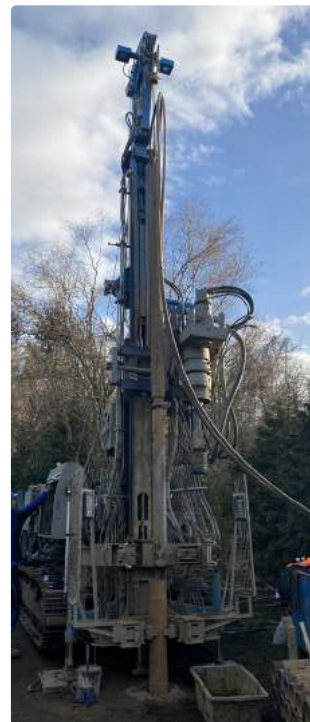
Das Kernbohrgerät nimmt am Rand von Freiburg Bohrproben.
