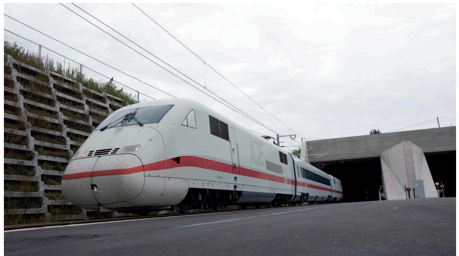
211 Tonnen auf 67,5 Meter Länge: Der ICE-S, der eine maximale Geschwindigkeit von 440 Kilometer pro Stunde erreichen kann.
