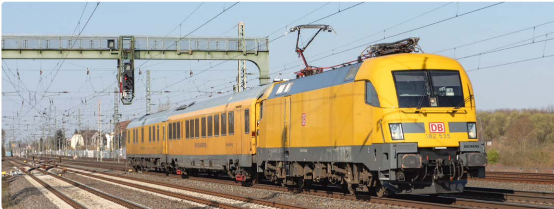
Gleismesszug im Einsatz
