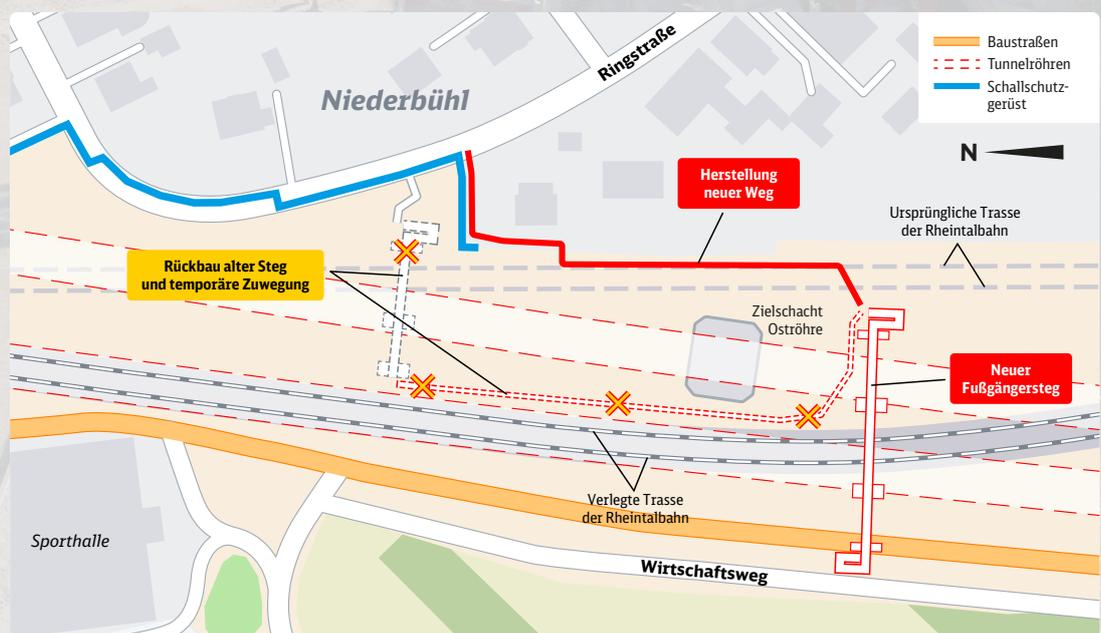
Der neue Fußgängersteg und seine Zuwegung im Endzustand. Der alte Steg wird im Anschluss zurückgebaut.
